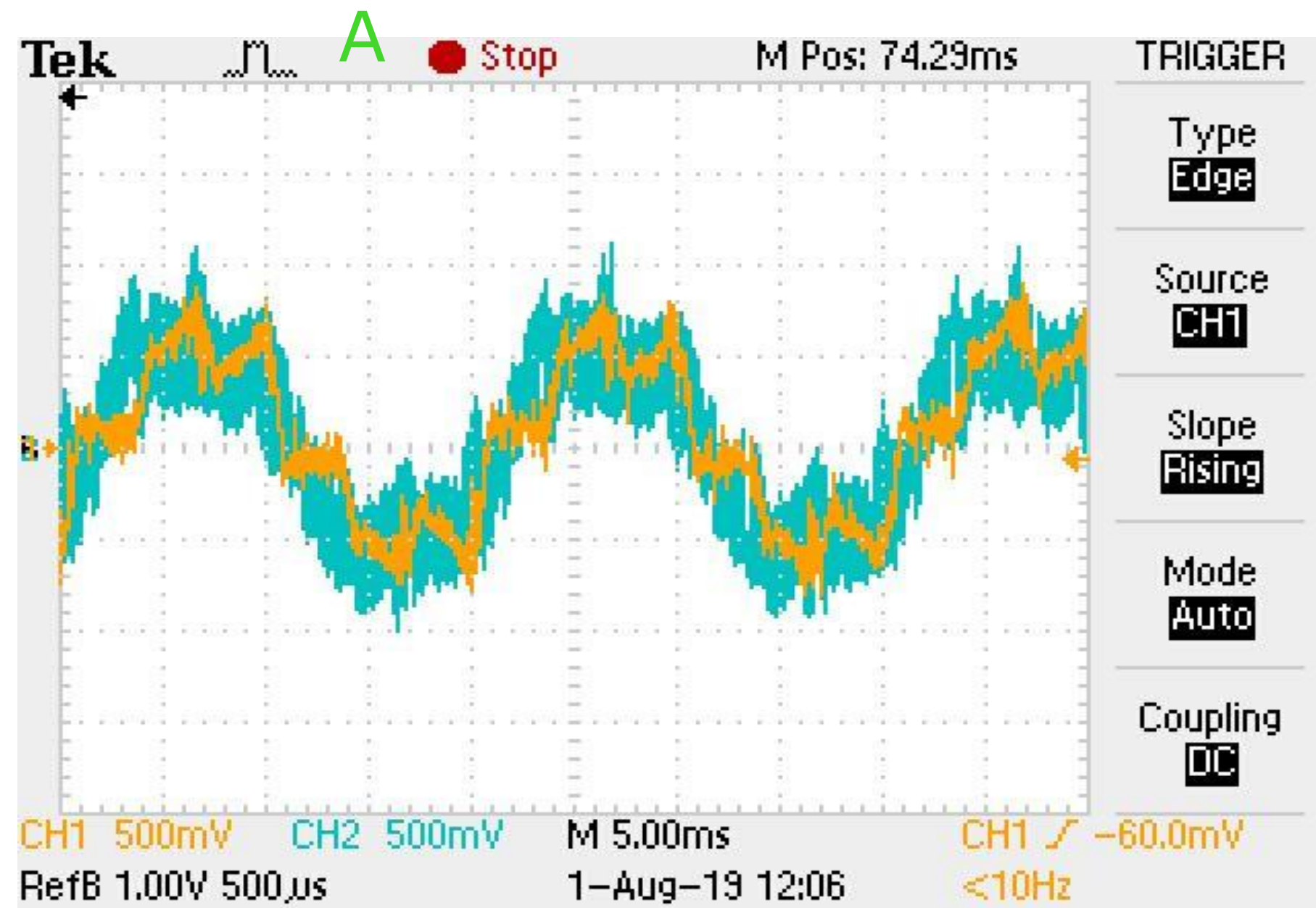
Napięcie fazowe i prąd fazowy na wejściu falownika 1VFC bez filtra harmonicznego LC ( I_{RMS} = ok. 5A)
